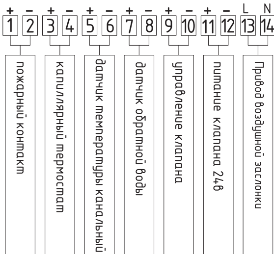
Рис. 9. Схема подключения автоматики ВПУ с водяным нагревателем для привода воздушной заслонки 230В с возвратной пружиной и приводом 3-х ходового клапана 24В, управление 0..10В.
